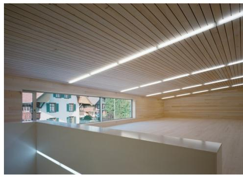
Das Holztragwerk besteht aus grossformatig vorgefertigten Dach- und Wandelementen, sowie Brettschichtholzträgern. Die Aussenwände sind als wandartige Träger ausgebildet, welche Spannweiten von bis zu ca. 17 m überbrücken.
